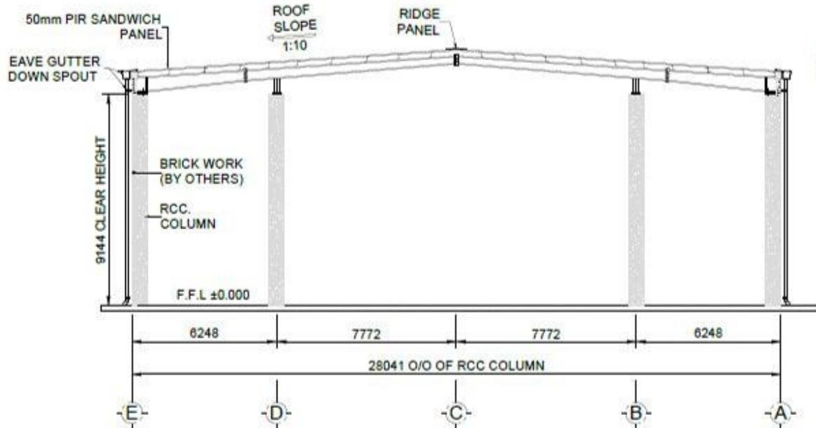
**RIGID FRAME ELEVATION @ GRID - 2 & 4**
