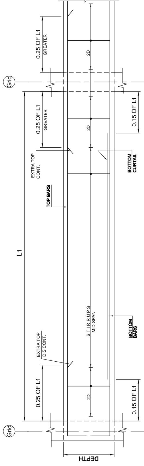
TYPICAL ELEVATION OF BEAM
